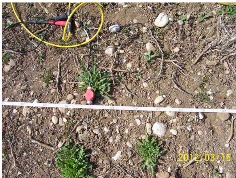
Foto 3.5.2. Sedimenti ghiaioso sabbiosi con limo (GSM.)
